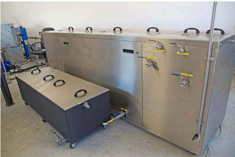
Das System ist auf der Rückseite mit einem Ölabscheidesystem ausgestattet.
